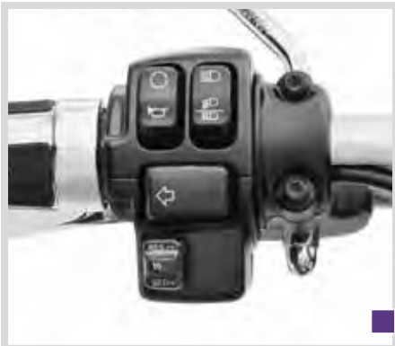
D. GESCHWINDIGKEITSREGELANLAGEN-KIT (41000369 ABGEBILDET)
